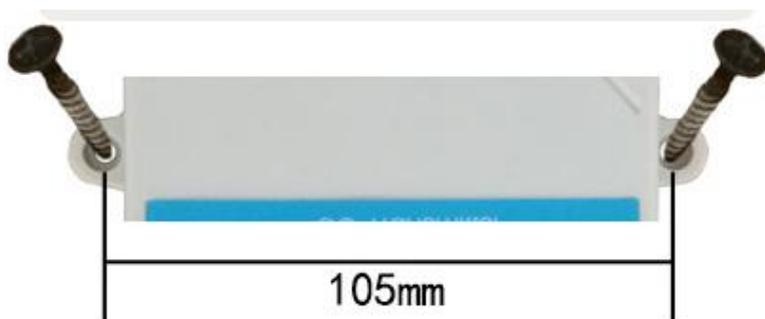
GPRS 型传感器采用壁挂式安装，安装孔位于设备两侧中部位位置，安装孔径小于 4mm，孔距 105mm，可使用 3mm 的自攻螺丝安装。
