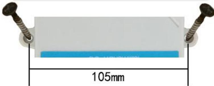
壁挂王子壳为壁挂式安装，安装孔位于设备两侧中部位置，安装孔径小于 4mm，孔距 105mm，可使用 3mm 的自攻螺丝安装。
