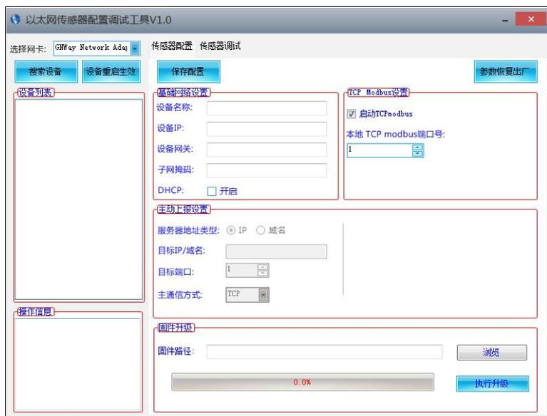
软件界面分为如下几部分，如图，左边为设备搜索和操作信息显示区域，中间为配置区域，可以进行设备的基本配置，传感器的调试与固件升级。
