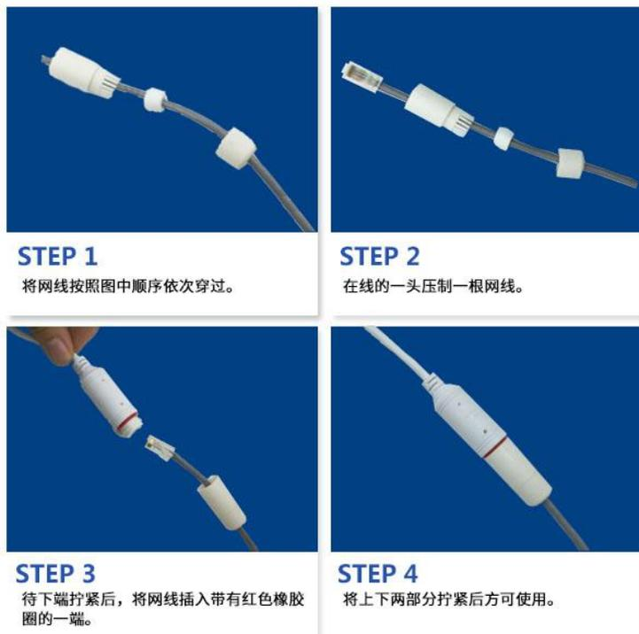
本产品配有一个默认的 RJ45 防水接头以适应室外的使用，如下图所示，请将网线穿过防水头后，再压制水晶头，然后插入网线并拧紧防水接头即可。
